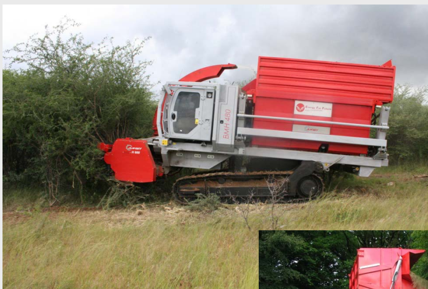
AHWI-Raupe BMH 480 mit aufnehmenden Mulcher H600
