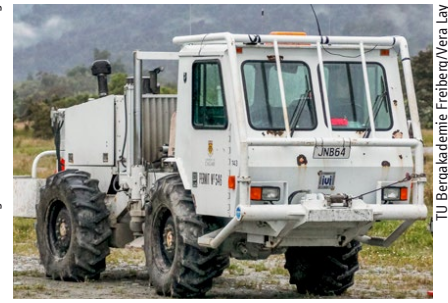
Rüttelfahrzeug, das Fahrzeug wiegt neun Tonnen.
